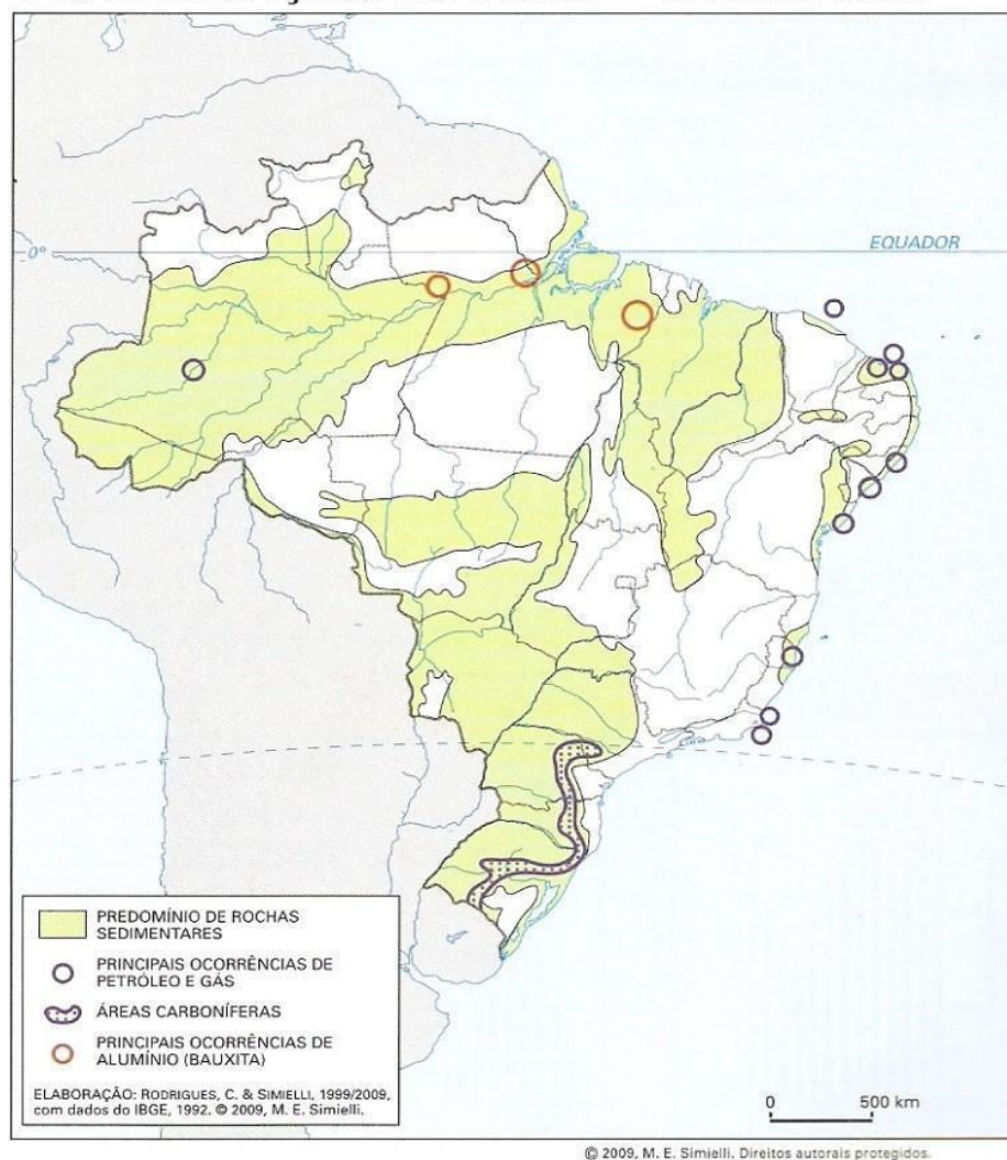
Figura 28. As reservas de minerais sedimentares estão nas bacias sedimentares. As maiores explorações de petróleo e gás natural estão no RJ e SP (petróleo marítimo-offshore), no litoral nordestino (terrestre-onshore, e marítimo) e no Amazonas (terrestre). O carvão é pouco, de baixa qualidade e concentrado no Sul, e o sal mineral é explorado principalmente no RN.
